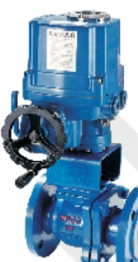
电动衬氟球阀 公称口径:DN15-300 公称压力:PN16-40 作用形式:开关型\调节型 阀座:PTFE 材质:铸钢衬氟\不锈钢衬 氟 电压:DC24\AC24V\ DC220\AC220\AC380
