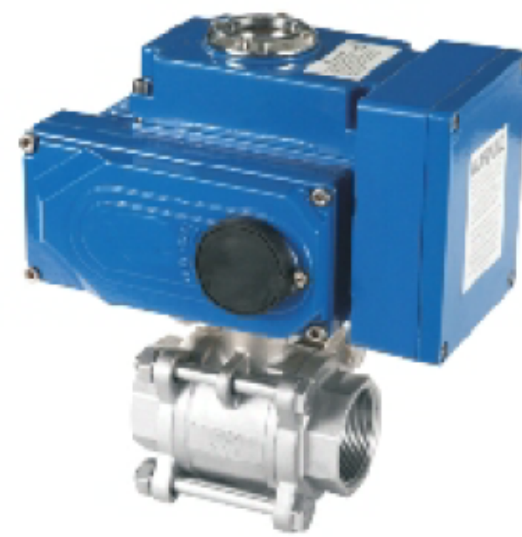
电动内螺纹球阀 公称口径:DN10-100 公称压力:PN16-320 作用形式:开关型\调节型 阀座:PTFE\PPL 材质:铸钢\不锈钢 电压:DC24\AC24V\ DC220\AC220\AC380
