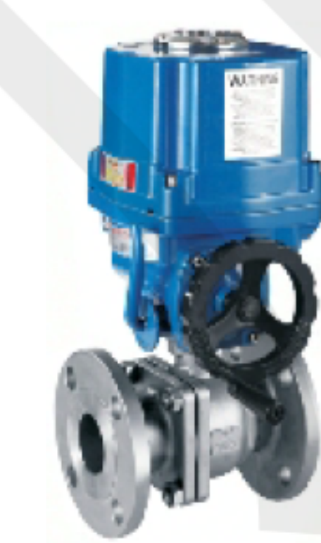
防爆电动球阀 公称口径:DN15-400 公称压力:PN16-320 作用形式:开关型\调节型 阀座:PTFE\PPL\H\Y 材质:铸钢\不锈钢 电压:DC24\AC24V\ DC220\AC220\AC380
