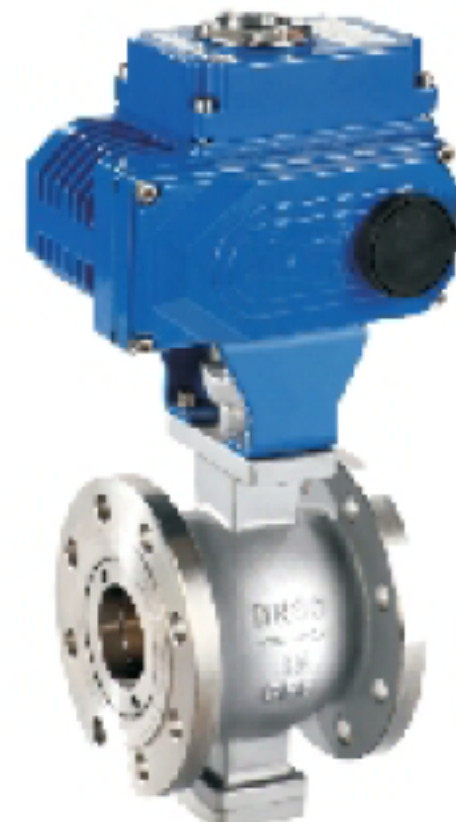
电动V型球阀 公称口径:DN25-400 公称压力:PN16-320 作用形式:开关型\调节型 阀座:PTFE\PPL\H\Y 材质:铸钢\不锈钢 电压:DC24\AC24V\ DC220\AC220\AC380
