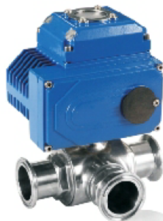
电动卫生级球阀 公称口径:19-102 公称压力:PN10-16 作用形式:开关型\调节型 阀座:PTFE 材质:不锈钢 电压:DC24\AC24V\ DC220\AC220\AC380
