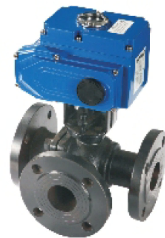
电动三通球阀 公称口径:DN15-300 公称压力:PN16-320 作用形式:开关型\调节型 阀座:PTFE\PPL\H\Y 材质:铸钢\不锈钢 电压:DC24\AC24V\ DC220\AC220\AC380
