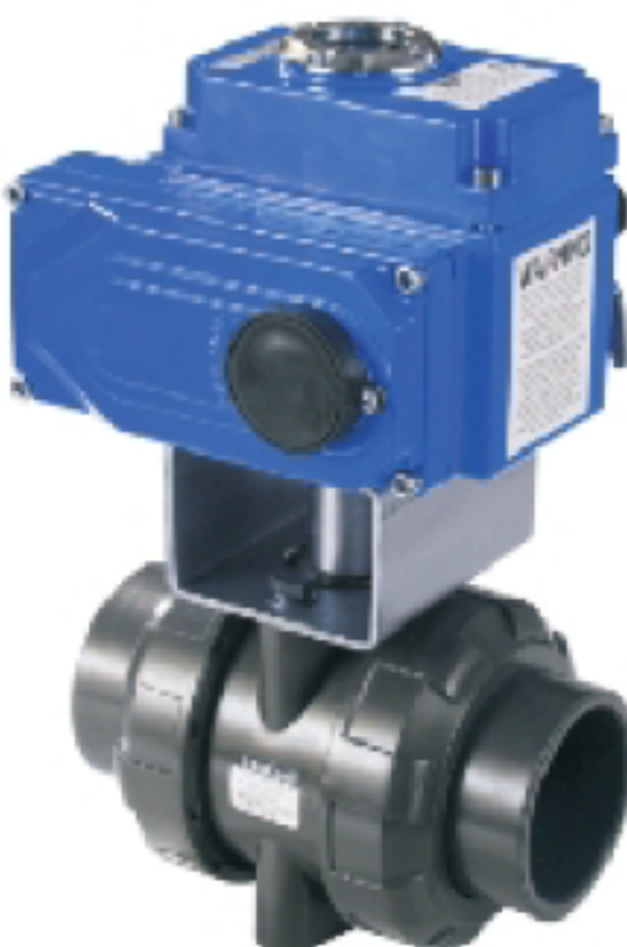
电动塑料球阀 公称口径:DN15-100 公称压力:PN10 作用形式:开关型\调节型 阀座:PTFE 材质:UPVC\PVDF 电压:DC24\AC24V\ DC220\AC220\AC380
