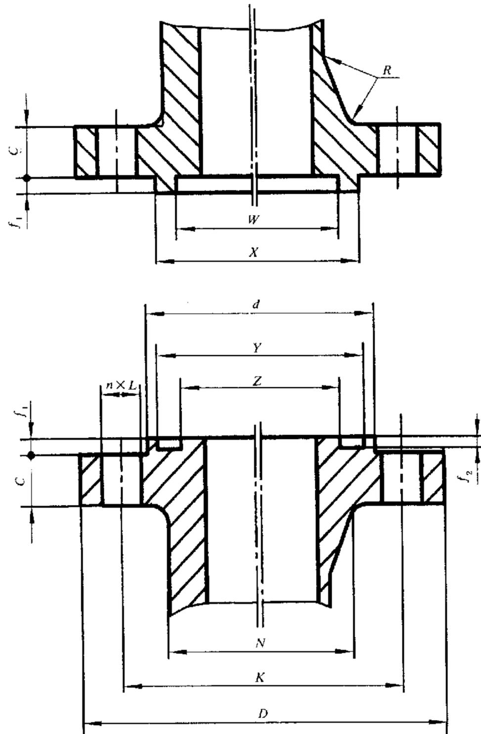
图 2 榫槽面(TG)整体钢制管法兰
